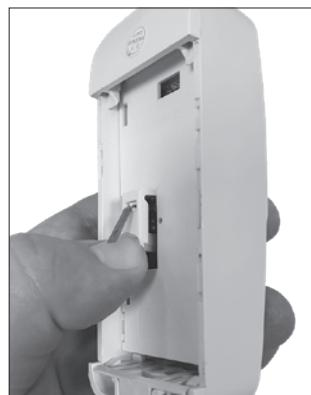
5). Затем пластиковый рычаг кнопки можно отпускать – распределитель переведен из режима «Sleep» в режим монтажа.
