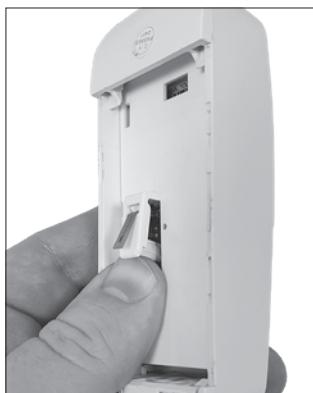
4). Нажать на пластиковый рычаг кнопки контроля вскрытия еще раз не менее, чем на 10 секунд.
