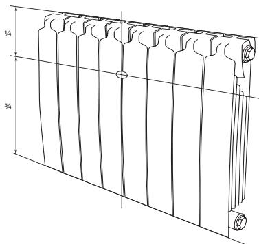
При нечетном количестве секций монтаж теплового адаптера производится между средней и соседней с ней секцией радиатора со стороны подводки.
