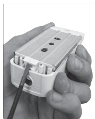
2). Кратковременно нажать на пластиковый рычаг кнопки контроля вскрытия на 1–2 секунды, но не более 5 секунд.
