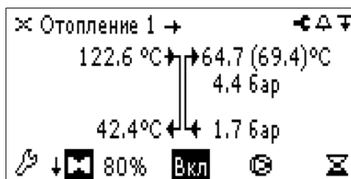
Рис. 24. Пример ручного управления клапаном и циркуляционным насосом СО1
