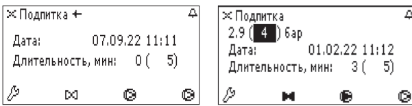
Рис. 23. Примеры главного экрана подпитки для конфигураций с управлением по реле (PS_ПОДП) — слева, и от датчика давления P обр_со — справа
