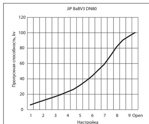
Максимально допустимый перепад давления dP в режиме регулирования расхода: 1,5/2,0 бар.
