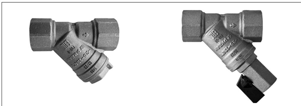
Фильтры латунные сетчатые применяются в системах холодного водоснабжения, отопления и горячего водоснабжения для защиты арматуры. Сетчатые фильтры улавливают инородные включения рабочей среды, такие как обломки шлака или капли от брызг, образованные при сварке, металлическая стружка, песок и т.д.
