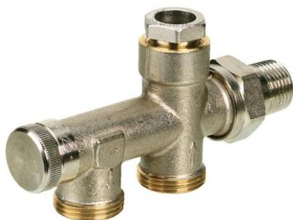
Клапаны запорные типа LV модификации LV-К предназначены для применения, как правило, в двухтрубных насосных системах водяного отопления с целью отключения отдельного отопительного прибора для его демонтажа или технического обслуживания без опорожнения всей системы. Не предназначены для контакта с питьевой водой в системах хозяйственно-питьевого водоснабжения.
