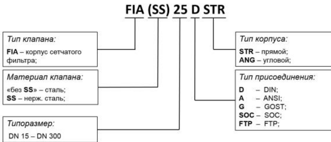
Рис. 3 Пример схемы обозначение FIA
