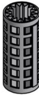
Фильтрующий элемент с гофрированной поверхностью
