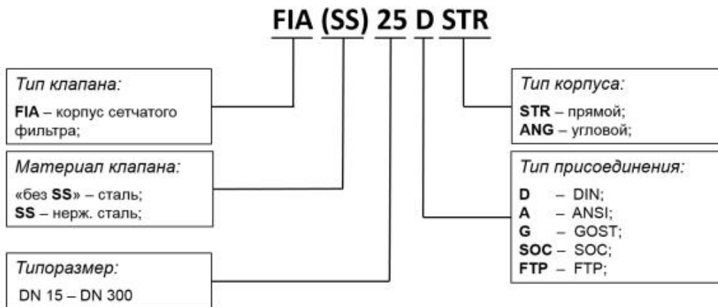
Рис. 3 Пример схемы обозначение FIA
