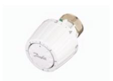
RTR 2945 — со встроенным температурным датчиком, защитой системы отопления от замерзания, диапазоном настройки температуры 5-26 °C, устройством для фиксирования и ограничения температурной настройки. Термоэлемент RTR2945 с соединительной гайкой следует использовать для клапанов Danfoss с присоединительной резьбой  $M30\times1,5$  серий RTD-N, RTD-G, РТД1, РТД2. Технические характеристики радиаторных терморегуляторов типа RTR соответствуют европейским стандартам EN 215-1 и ГОСТ 30815-2002.
