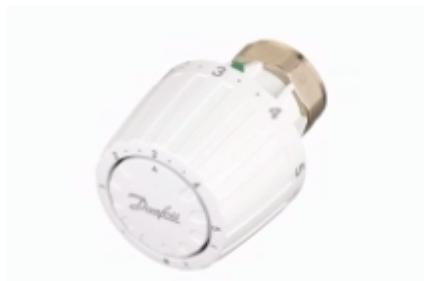
RTR 2945 – со встроенным температурным датчиком, защищая систему отопления от замерзания, диапазоном настройки температуры 5 – 26 °C, устройством для фиксирования и ограничения температурной настройки. Термоэлемент RTR2945 с соединительной гайкой следует использовать для клапанов Danfoss с присоединительной резьбой M30×1,5 серий RTD-N, RTD-G, РТД1, РТД2.
