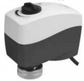
Приводы электрические типа AMV 140H предназначены для работы с клапанами регулирующими типов VZ и VZL, управляющими подачей тепло- и холодоносителя в фэнкойлы или небольшие вентиляционные установки.
