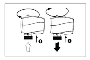
1. При ручном позиционировании нажать и удерживать кнопку в нижней части привода. Примечание: Щелчок после подачи напряжения на привод означает, что шестерня редуктора заняла рабочее положение.
