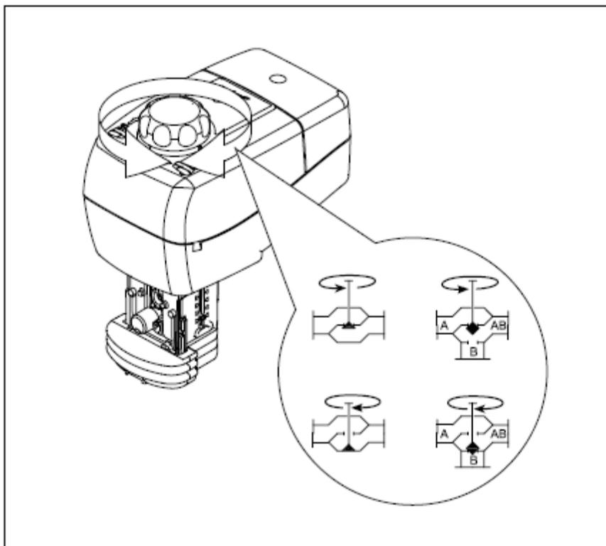
Ручное позиционирование производится вращением рукоятки на крышке привода. Для выполнения позиционирования следует:
