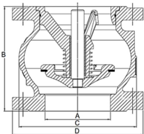
Габаритные и присоединительные размеры клапанов обратных тип NVD 402.
