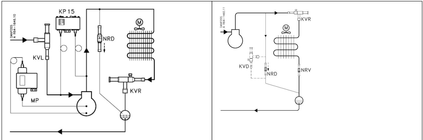
В том случае, если в ресивере необходимо поддерживать определенное давление, не зависящее от текущего давления на линии нагнетания, вместо клапана-регулятора перепада давления типа NRD в комплекте с клапаном типа KVR рекомендуется использовать клапан-регулятор давления типа KVD.
