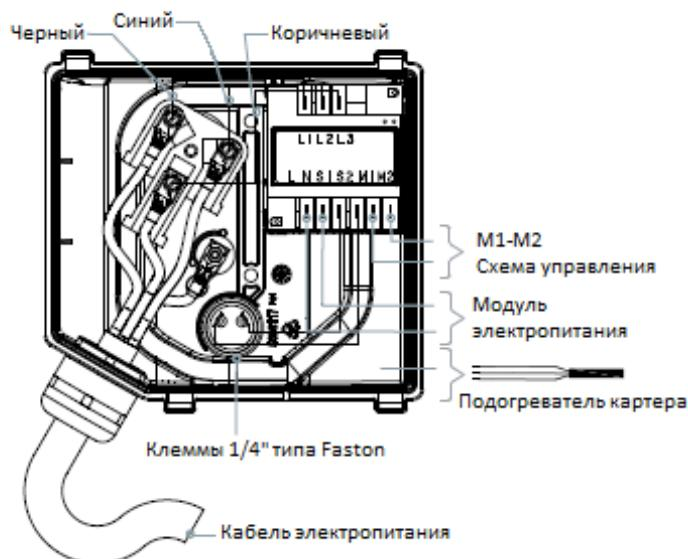
На клеммной коробке имеется отверстие Ø 50.5 мм (ISO50) (UL 1" 1/2 дюйма для кабеля) с возможным пробивным отверстием Ø 63.5 мм (ISO63) (UL 2" для кабеля) для электрического кабеля и 2 пробивных отверстия Ø 22.5 мм (PG16) (UL 1/2" для кабеля) для устройств защиты цепи управления.
