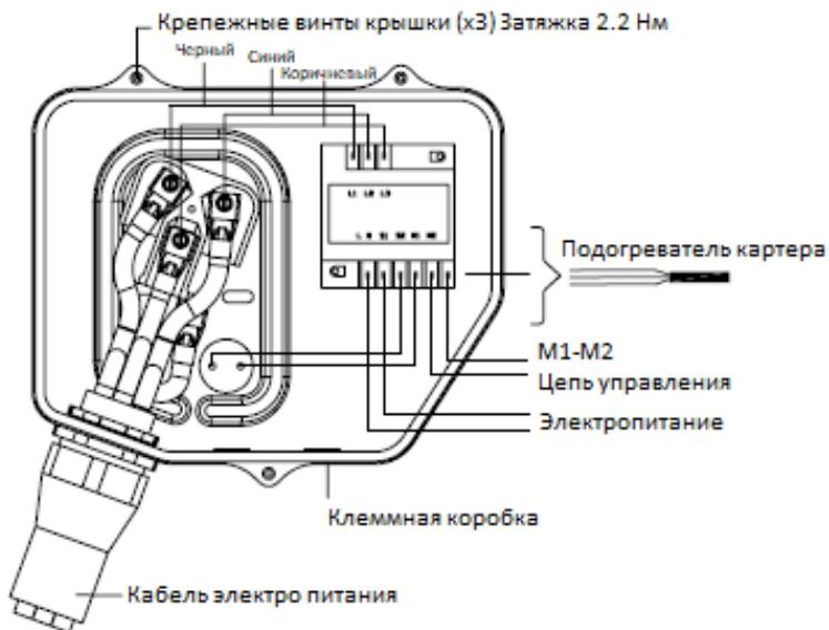
Степень защиты клеммных коробок компрессоров всех моделей составляет IP54 в соответствии со стандартом IEC529. Степень защиты действительна только в случае использования кабельных вводов правильного размера.
