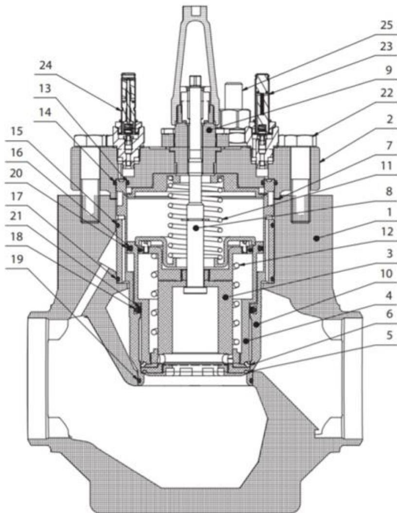
**Рис. 1 Конструкция клапанов ICLX 100 - 150**
