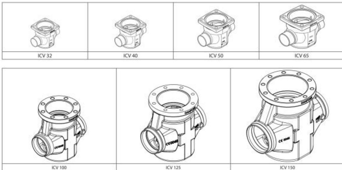
Корпусы клапанов регуляторов давления типов ICV 32, ICV 40, ICV 50, ICV 65 имеют присоединительные штуцеры нескольких типов и размеров – от размеров меньше номинального, до размеров больше номинального.
