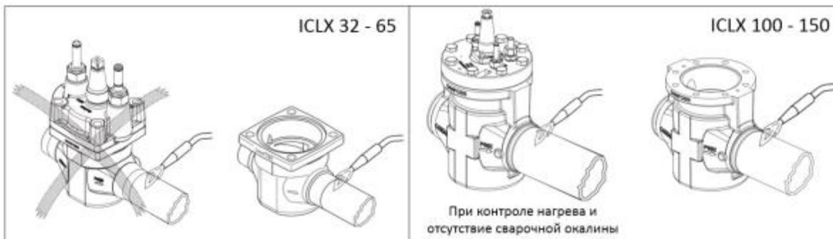
Верхняя крышка и функциональный модуль могут быть сняты путем приложения вертикального усилия на прорезях, как указано на рисунке ниже.
