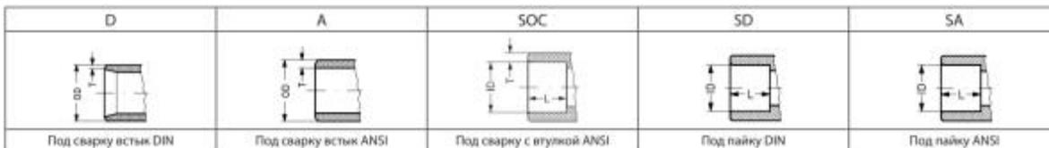
Клапаны регуляторы давления типов ICV 100, ICV 125, ICV 150 имеют присоединительные штуцеры под сварку встык DIN и под сварку встык ANSI номинальных размеров.
