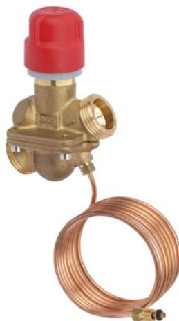
Клапаны балансировочные типа АВ-РМ (далее клапан АВ-РМ) – регуляторы постоянства перепада давлений, предназначенные для гидравлической балансировки систем отопления при переменных расходах проходящего через него теплоносителя в диапазоне от 0 до 100%.
