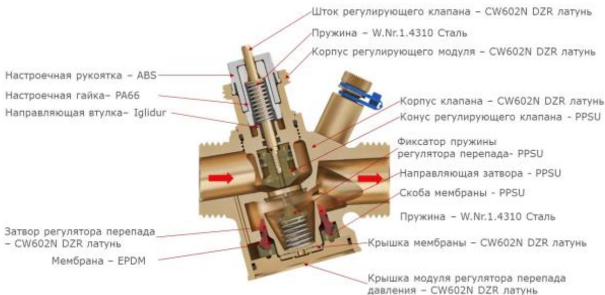
На этикетке указаны DN, Kvs, PN, тип, кодовый номер, штрих-код, дата производства в формате нн/гг. Маркировка на клапане: обозначения на корпусе.
