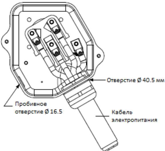
Степень защиты клеммных коробок компрессоров всех моделей составляет IP54 в соответствии со стандартом IEC529. Степень защиты действительна только в случае использования кабельных вводов правильного размера.
