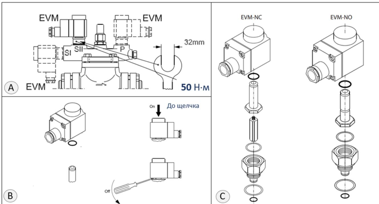
Рис. 3 – Установка клапана и электромагнитной катушки
