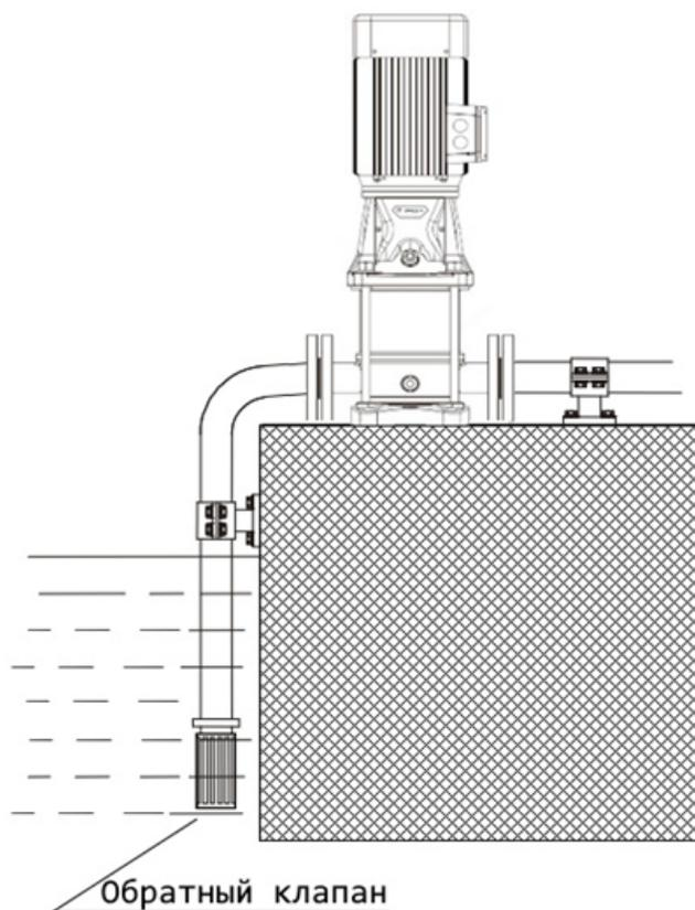
Всасывающий трубопровод и насос перед пуском должны быть заполнены рабочей жидкостью, а воздух из них должен быть удален.
