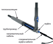
Установка внутри трубы
