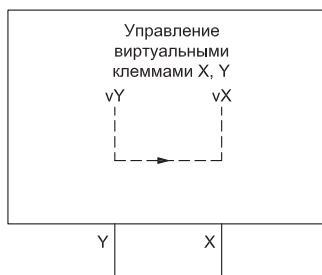
Виртуальное соединение клемм X и Y
