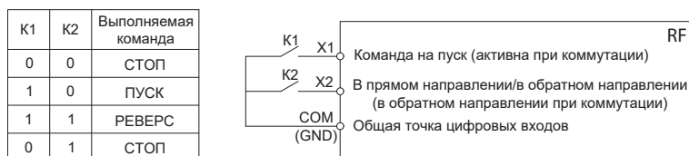
Рисунок 10.9-6. Двухпроводная схема управления 2
