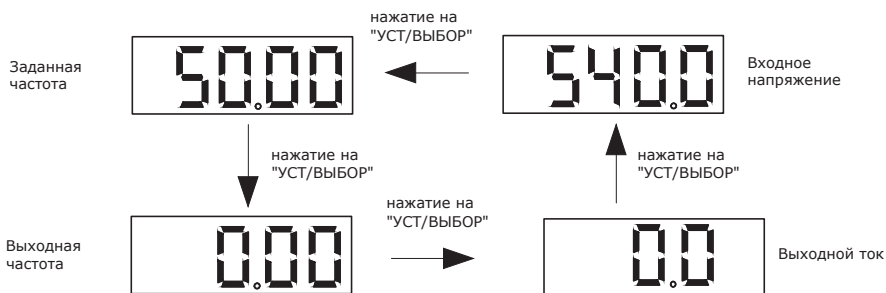
Рисунок 5.5-2. Переключение контролируемых параметров
