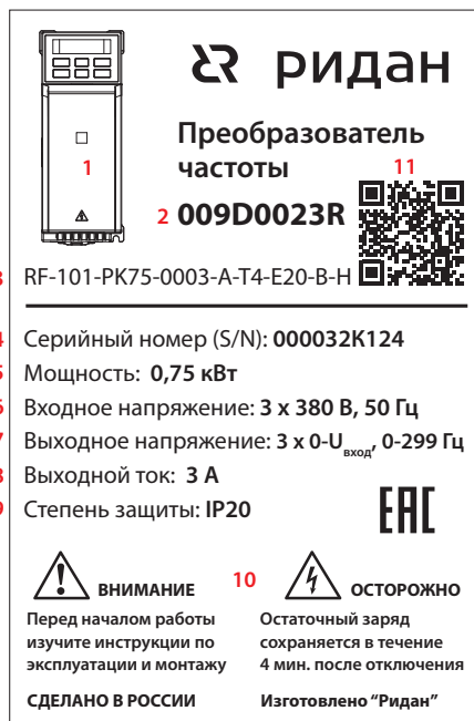
Рисунок 1.3-1. Пример маркировки преобразователя частоты
