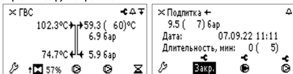
Рис. 31. Примеры ручного управления клапаном ГВС и подпитки
