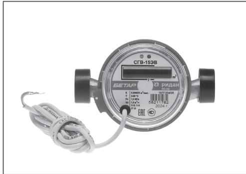
Счетчики воды бытовые универсальные механические СГВ-15МВ/СГВ-20МВ и электронные СГВ-15ЭВ/СГВ-20ЭВ предназначены для измерения объема холодной и горячей питьевой воды по СанПиН 1.2.3685-21, протекающей по трубопроводу при температуре от плюс 5 до плюс 90 °С при давлении не более 1,0 МПа (10 кгс/см<sup>2</sup>).
