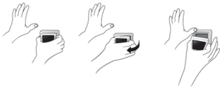
Рис. 8. Демонтаж модуля дисплея.
