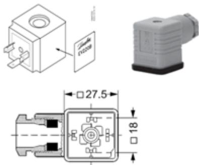
Для предотвращения попадания влаги в клеммную коробку через кабельный ввод кабель должен быть закреплен по всему диаметру и установлен так, как это показано на рисунке. Следует учесть, что надежное уплотнение обеспечивается только для кабелей круглого сечения.
