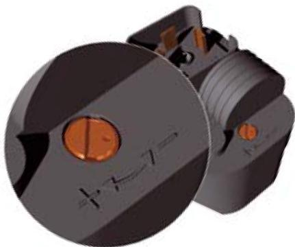
Значение давления, при котором вентилятор будет вращаться с максимальной скоростью, может быть изменено с помощью регулировочного винта. Плюсом обозначено направление, при вращении в котором регулировочного винта уставка давления срабатывания повышается. При данном давлении напряжение питания и, как следствие, скорость вращения, составляют 95% от номинального значения.
