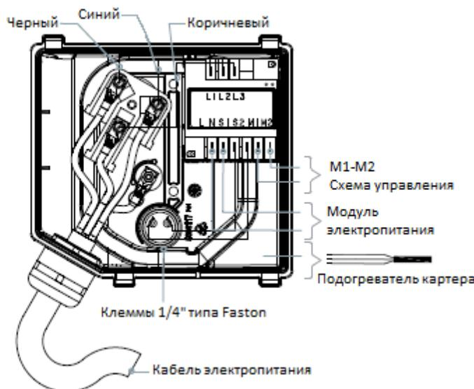
Степень защиты клеммных коробок компрессоров всех моделей составляет IP54 в соответствии со стандартом IEC529. Степень защиты действительна только в случае использования кабельных вводов правильного размера.
