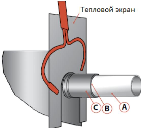
Переместите горелку на участок С, чтобы припой смог затечь в зазоры стыка. Подавайте тепло к участку С на короткое время, чтобы припой не попасть в компрессор.
