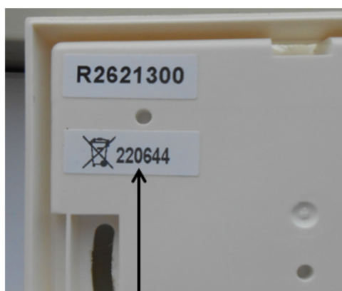
Вид стикера с датой на задней стенке регулятора
