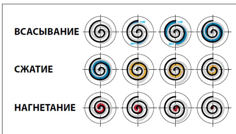
В компрессоре сжатие газа производится двумя элементами, имеющими форму спиралей, которые расположены в верхней части компрессора над электродвигателем (см. рисунок вверху). Всасываемый
