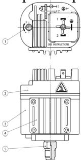
Для предотвращения перегрева и увеличения срока службы на корпусе регулятора скорости вращения вентиляторов типа XGE установлен теплоотводящий радиатор.
