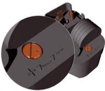
Значение давления, при котором вентилятор будет вращаться с максимальной скоростью, может быть изменено с помощью регулировочного винта. Плюсом обозначено направление, при вращении в котором регулировочного винта уставка давления срабатывания повышается. При данном давлении напряжение питания и, как следствие, скорость вращения, составляют 95% от номинального значения.
