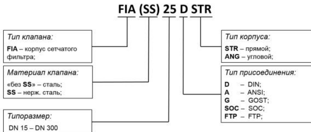
Рис. 3 Пример схемы обозначение FIA
