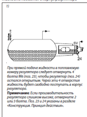
Жидкость поступает в испаритель
