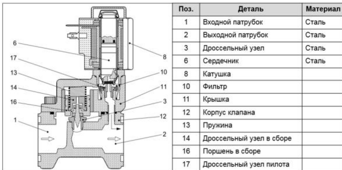
Рис. 1 Конструкция клапанов AKVA 15
