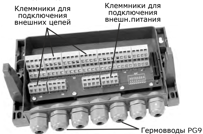
Рис. 2.4 – Вид на монтажный отсек при снятой крышке
