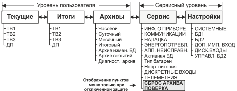
Рис. 2.6 – Структура меню тепловычислителя
