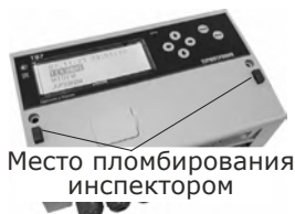
б) Пломба инспектора снабжающей организации
