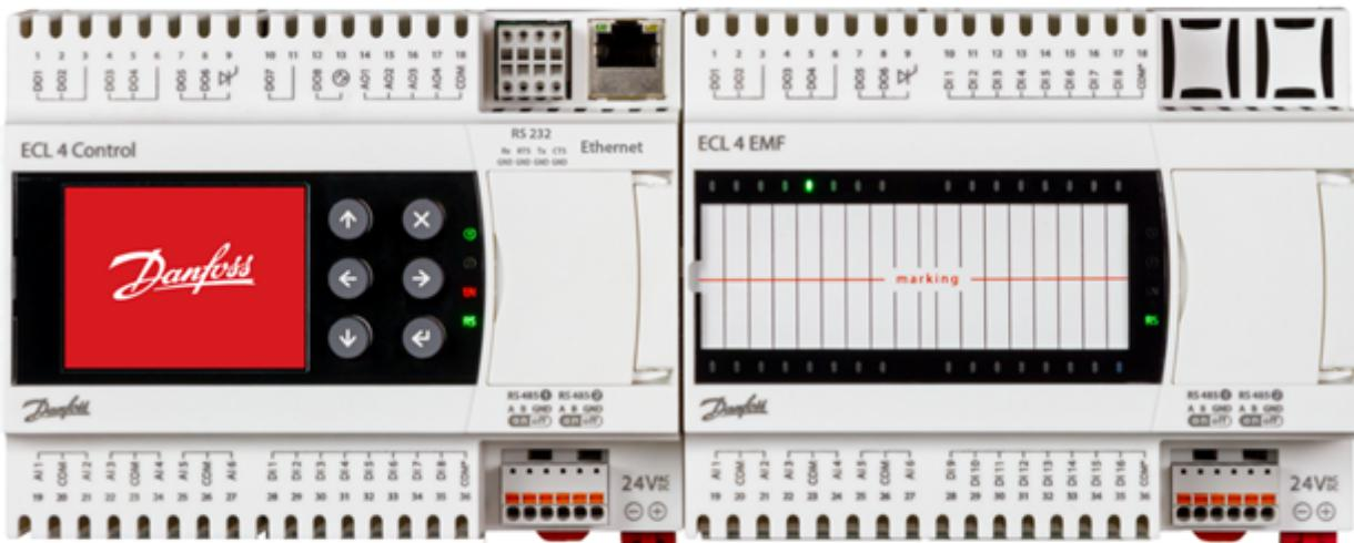
Конфигурируемые электронные регуляторы ECL4 Control 368 Plus Ethernet обеспечивают регулировку температуры теплоносителя, поступающего в систему отопления, в зависимости от температуры наружного воздуха в соответствии с температурным графиком в целях обеспечения заданной температуры воздуха в отапливаемых помещениях здания, а также поддерживать требуемую температуру горячей воды в системе ГВС.
