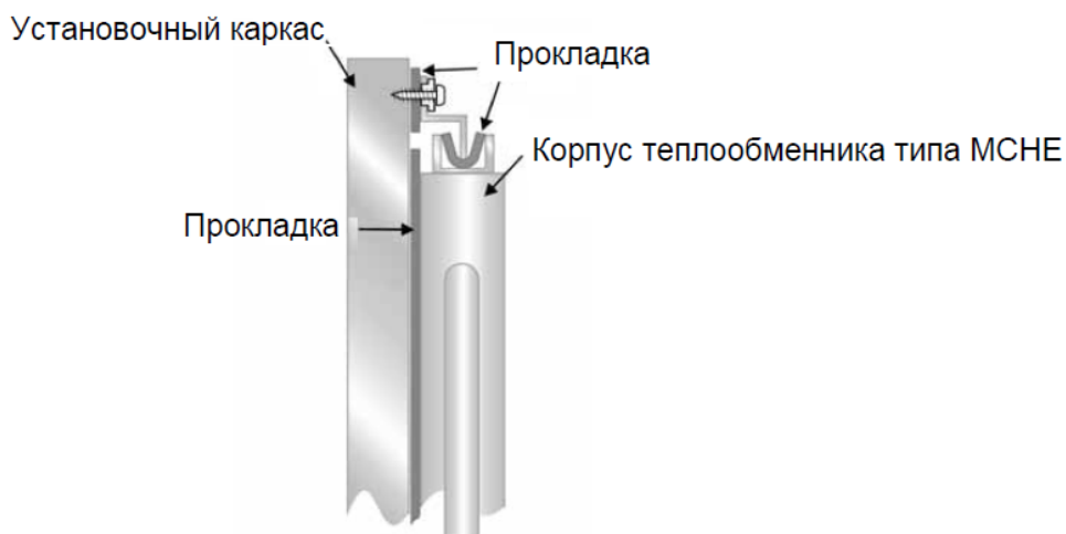
Монтаж теплообменников микроканальных типа МСНЕ.
