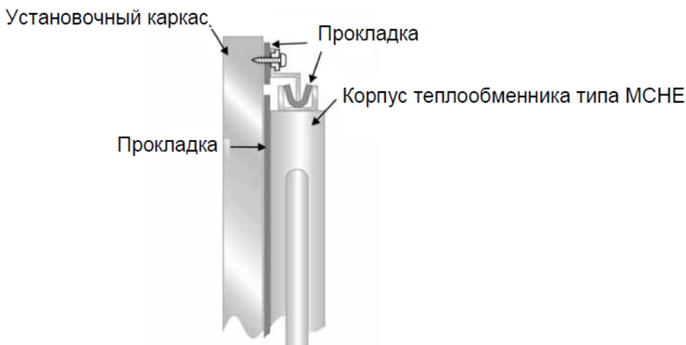
Монтаж теплообменников микроканальных типа МСНЕ.
