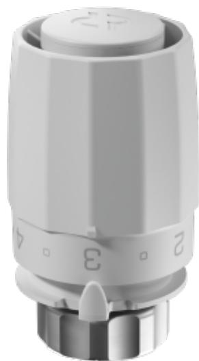
Терморегулятор радиаторный представляет собой пропорциональный регулятор температуры воздуха прямого действия с малой зоной пропорциональности, которыми в настоящее время оснащаются системы отопления зданий различного назначения.
