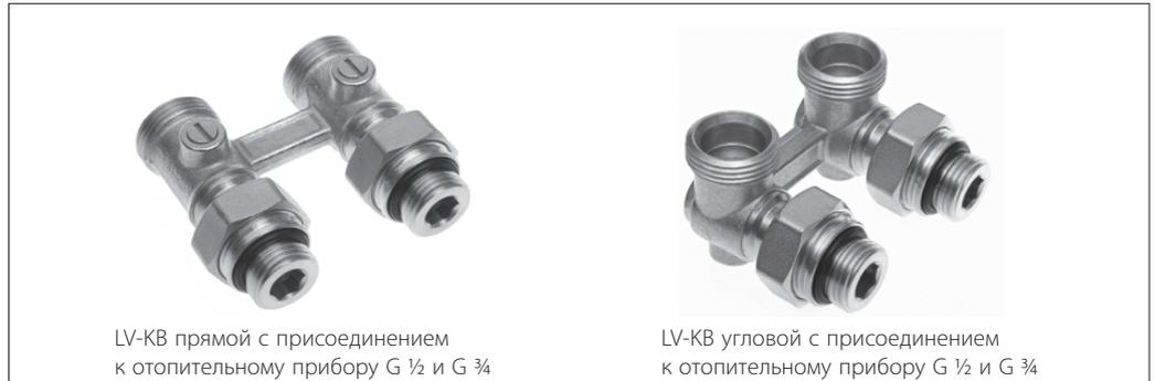
Клапан запорно-присоединительный LV-KB применяется в двухтрубных системах отопления для подключения отопительных приборов с нижним расположением присоединительных штуцеров с межосевым расстоянием 50 мм. Клапан LV-KB не подходит для присоединения к нему спускного крана.
