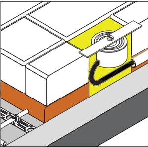
Монтаж датчика грунта выполняется совместно с монтажом нагревательного кабеля. Для этого в месте монтажа датчика необходимо предусмотреть углубление 100x100x130 мм, к которому необходимо подвести трубку с протяжкой Ø16 мм для монтажа кабеля датчика (см. рис.).
