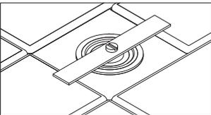
Зафиксируйте датчик цементно-песчаной смесью.
