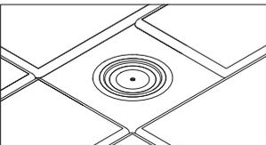
Перед началом эксплуатации системы демонтируйте монтажную пластину и очистите поверхность датчика.
