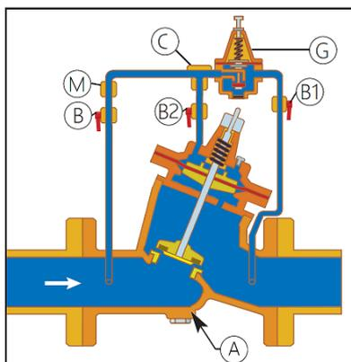
При работе регулятора под давлением закрыть отсечной кран В1 (см. рис.) на импульсной арматуре. Регулятор должен закрыться полностью. Отсечной клапаны В, и регулятор потока в узле С (см. рис.) импульсной арматуры должны быть открыты.
