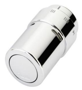
Элементы термостатические типа RAX — устройства автоматического регулирования температуры, предназначенные для комплектации радиаторных терморегуляторов с присоединением RTR (RA). Терморегулятор радиаторный представляет собой пропорциональный регулятор температуры воздуха прямого действия с малой зоной пропорциональности, которыми в настоящее время оснащаются системы отопления зданий различного назначения.
