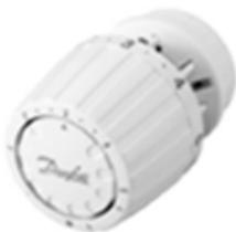
RTR 2940 – со встроенным температурным датчиком, защитой системы отопления от замерзания, диапазоном настройки температуры 0 – 26 °С, устройством для фиксирования и ограничения температурной настройки. В отличие от элемента модификации RTR 2994 термоэлемент модификации RTR 2940 дополнительно имеет функцию, обеспечивающую 100 % перекрытие клапана терморегулятора;
