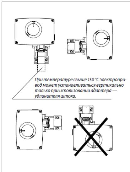
Примечание. При температуре теплоносителя выше 150 °C электропривод без адаптера – удлинителя штока должен устанавливаться на клапан только горизонтально.
