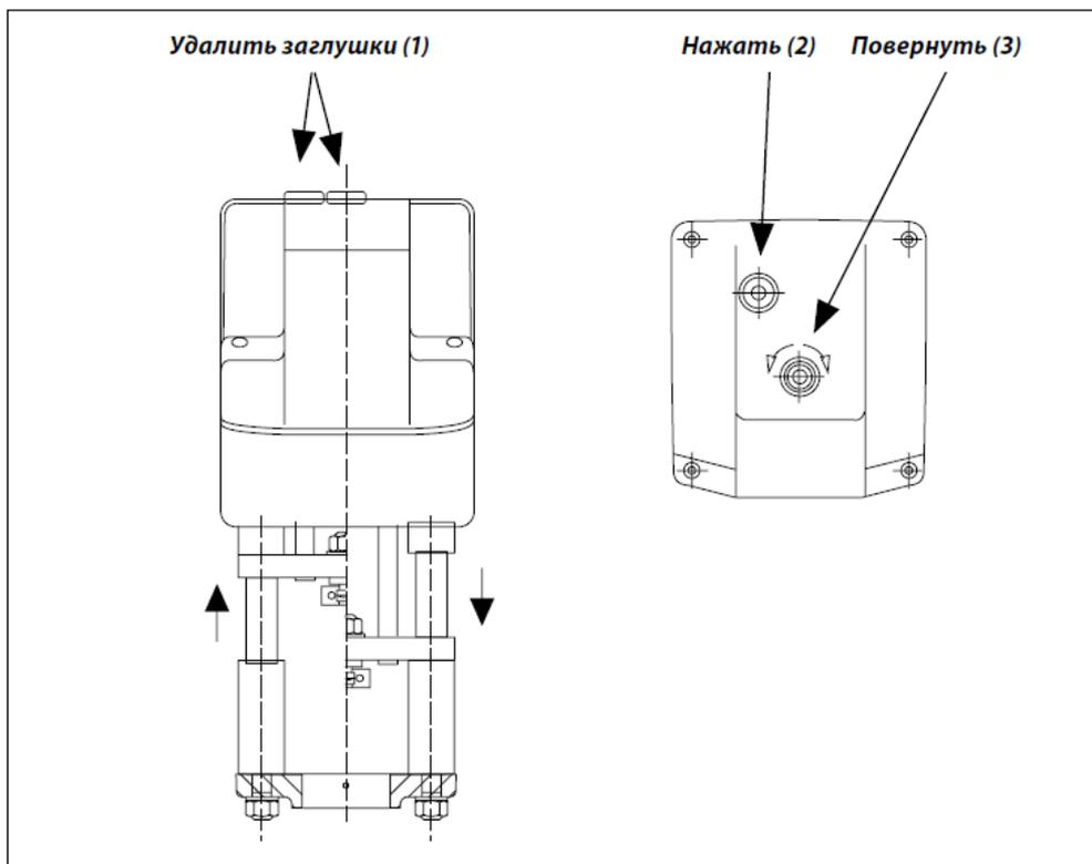
Ручное позиционирование производится 8-мм торцевым шестигранным ключом (не входит в комплект поставки), поворотом его до требуемого положения.
