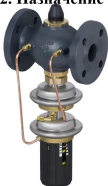
Клапан-регулятор давления модификации AVPQ 4 является регулятором прямого действия для поддержания постоянного перепада давлений с автоматическим ограничением предельного расхода теплоносителя.
