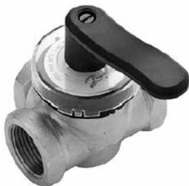
Клапаны регулирующие типа HRB модификации 3 (далее- клапаны регулирующие типа HRB3) предназначены для применения в системах теплоснабжения, где допускается некоторая протечка теплоносителя через закрытый клапан. Клапаны регулирующие HRB3 можно использовать совместно с приводами электрическими редукторными AMB 162 или AMB 182.
